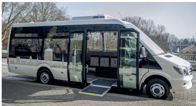
▲ Die zweiflügelige Schwenkschiebetür bietet genug Durchgangsweite für eine manuell aufklappbare Rollstuhlrampe Foto: Daimler AG
